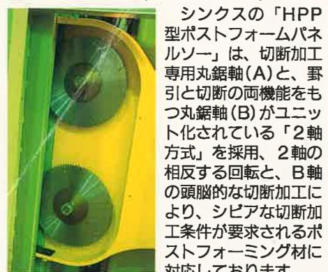
シンクスの「HPP型ポストフォームパネルソー」は、切削加工専用丸鋸軸(A)と、野引と切削の両機能をもつ丸鋸軸(B)がユニット化されている「2軸方式」を採用、2軸の相反する回転と、B軸の頭脳的な切削加工により、シビアな切削加工条件が要求されるポストフォーミング材に対応しております。
